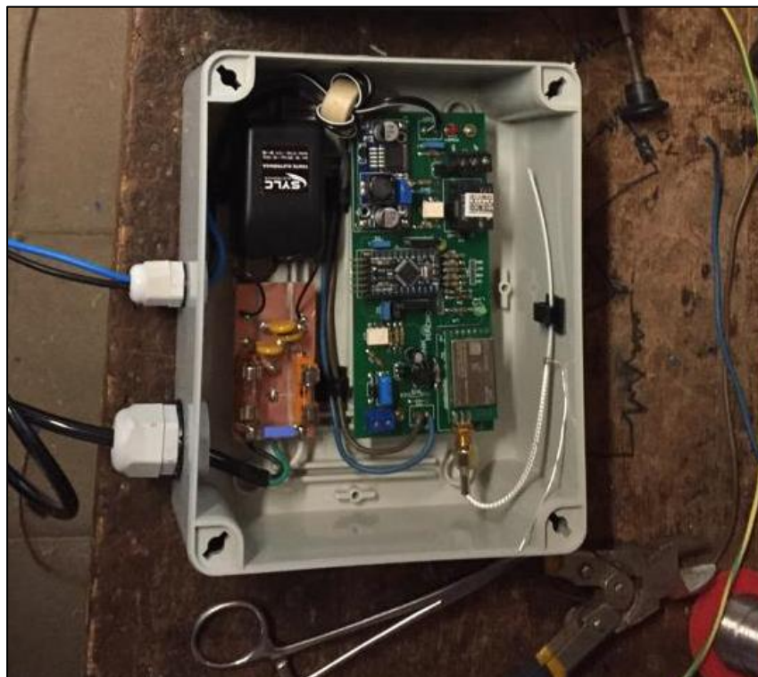
Figura 30: Montagem final da estação de aquisição de dados e controle do lado de controle. Fonte: Do autor.
