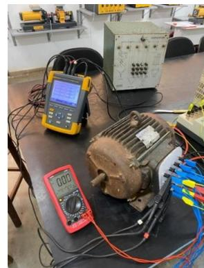
Fig 10 Motor de Indução Trifásico da EBERLE (modificado) utilizado nos experimentos. Fonte: Própria.
