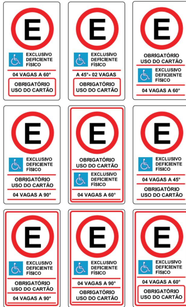
Fig. 12. Modelo de sinalização vertical de vagas de estacionamentos destinadas ao deficiente físico
