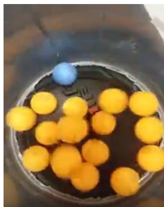
Figura 19. Imagem de uma simulação pressão versus número de moles no Simulador de Movimento Vibracional (SMMV) para 16 bolinhas. Fonte: Do autor. Vídeo disponível no link: https://drive.google.com/file/d/1itmb1AjjhI5cbQMfa3zWs7_JKHUhad .
