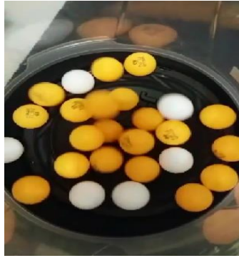
Figura 20. Imagem de uma simulação pressão versus número de moles no Simulador de Movimento Vibracional (SMMV) para 25 bolinhas. Fonte: Do autor. Vídeo disponível no link: https://drive.google.com/open?id=1bR0cVHsRfRAfFIWMIuvxsmDStvMldJz .
