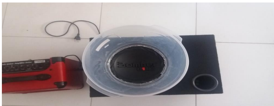
Figura 10. Amplificador acoplado a caixa de som e cilindro plástico de 5 L. Fonte: Do autor.
