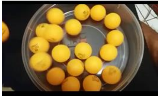
Figura 22. Imagem de uma simulação da evaporação em um líquido ou gás no Simulador de Movimento Vibracional (SMMV) para 26 bolinhas. Fonte: Do autor. Vídeo disponível no link: https://drive.google.com/open?id=1yEeP1KpRsh46ycdJhWNEcC620_pCLBZ5 .
