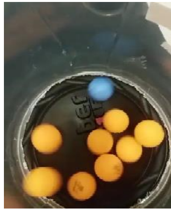
Figura 18. Imagem de uma simulação pressão versus número de moles no Simulador de Movimento Vibracional (SMMV) para 10 bolinhas. Fonte: Do autor. Vídeo disponível no link: https://drive.google.com/file/d/1tloZ2NGrPa-GgAk3rrdH2q8fuMIVQdHH
