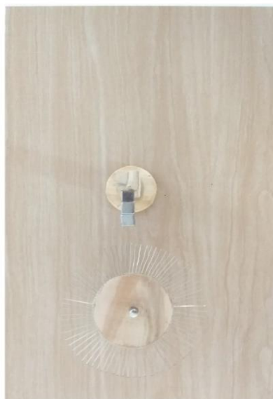
FIGURA 7. Montagem do motor de Curie. Fonte: próprio autor.
