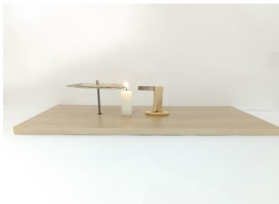
FIGURA 11. Montagem do motor de Curie. Fonte: próprio autor.
