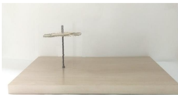
FIGURA 6. Montagem do motor de Curie. Fonte: próprio autor.
