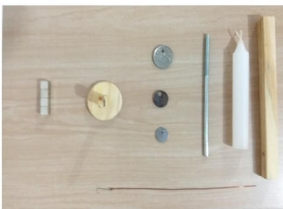
Figura 1. Materiais utilizados na montagem do pêndulo. Fonte: próprio autor.
