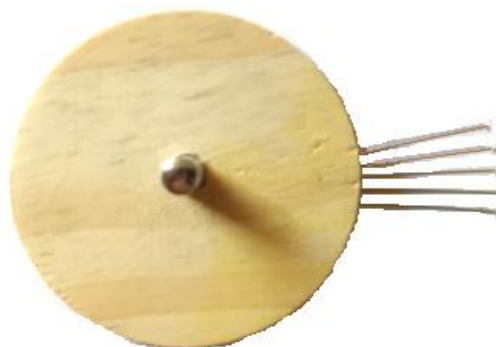
FIGURA 5. Montagem do motor de Curie. Fonte: próprio autor.
