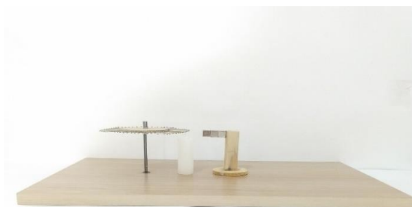
FIGURA 8. Montagem do motor de Curie. Fonte: próprio autor.
