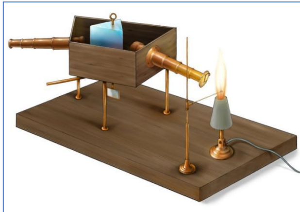
Figura 6 - Ilustração de um espectroscópio desenvolvido por Bunsen e Kirchhoff, em 1860.
