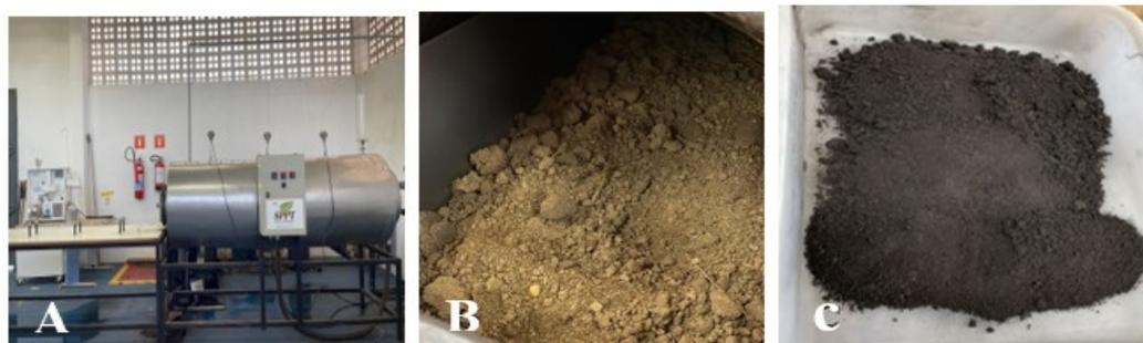
**Figura 1** - *Biochar* de lodo de esgoto utilizado no experimento. (A): Reator de pirólise batelada, utilizada para processar o material. (B): Lodo de esgoto *in natura*. (C): *Biochar* sendo preparado para aplicação ao solo, passado em peneira de 4,75 mm.
